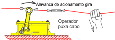
Fig. 8 - Acionamento da emergência
