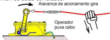
Fig. 8 - Acionamento da emergência
