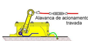
Fig. 9 - Chave travada na emergência
