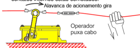
Fig. 8 - Acionamento da emergência
