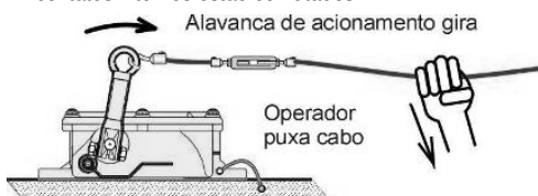
Fig. 8 - Acionamento da emergência
