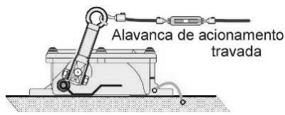
Fig. 9 - Chave travada na emergência
