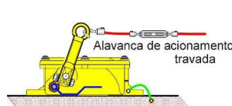
Fig. 9 - Chave travada na emergência
