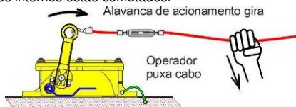
Fig. 8 - Acionamento da emergência
