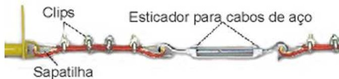
Fig 2 - Fixação do cabo na chave
